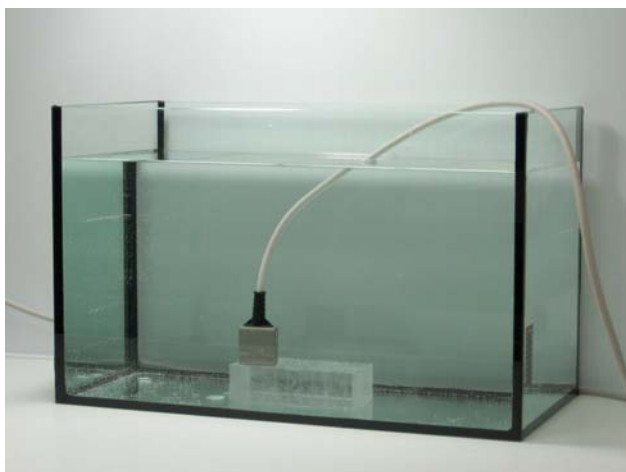
Рисунок 5 Герметичный съёмный преобразователь ДААН, испытываемый методом погружения на глубину 15 см
