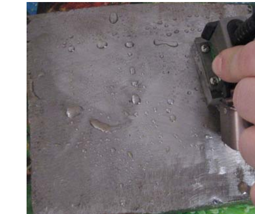
Рис. 1. Первый объект контроля. Фрагмент стальной трубы толщиной 18 мм с характерной ликвационной зоной в основном металле.
