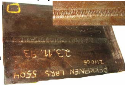
Рис. 8. 3 образец - фрагмент трубопровода с дефектным стыковым сварным соединением.
