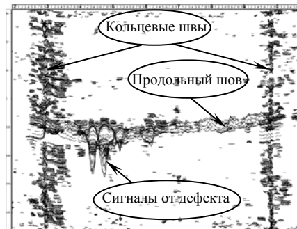
Рис.3. Данные магнитного обследования с поперечным намагничиванием (TFI)
